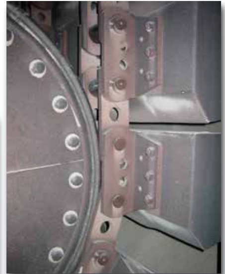
Optimización THIELE de una cadena para elevador de cangilones: la selección de materiales, tratamientos térmicos y elementos de máquina de la más alta calidad prolonga los intervalos de mantenimiento.
