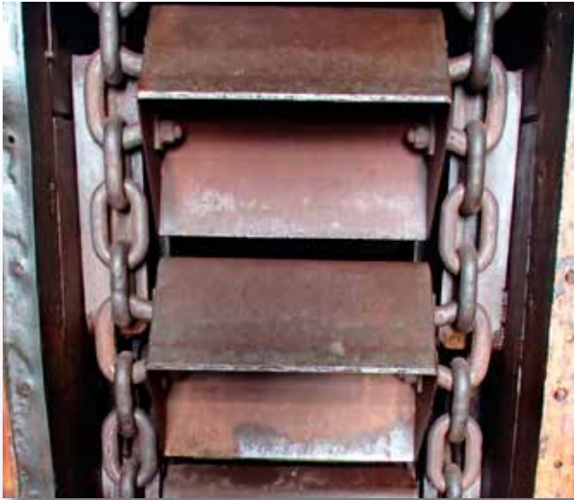
Jarzmo łańcucha wg DIN 5699
